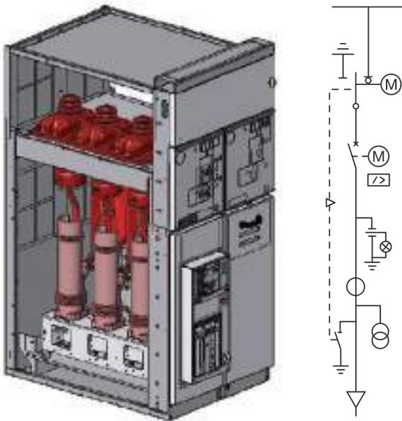
Ячейка силового выключателя типа SBC выполнена для защиты кабельных линий, двигателей, трансформаторов, конденсаторных батарей и т. д. Ячейка может быть оборудована вакуумным или элегазовым силовым выключателем. Выключатель установлен на направляющую и соединен с шинами. Для изолирующих операций предусматривается выключатель нагрузки с 3 положениями, оборудованный заземлителем и установленный между силовым выключателем и шинами.
