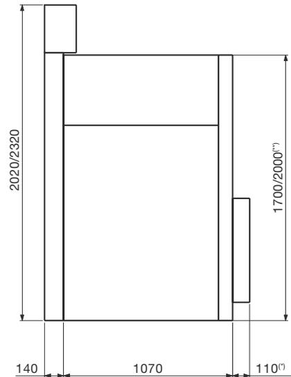
(\*) Для ячеек со съемными и выкатными выключателями
