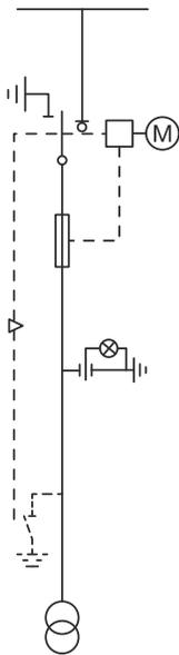
Ячейка SFV с выключателем нагрузки, оснащенный плавкими предохранителями, используется прежде всего для измерения напряжения.
