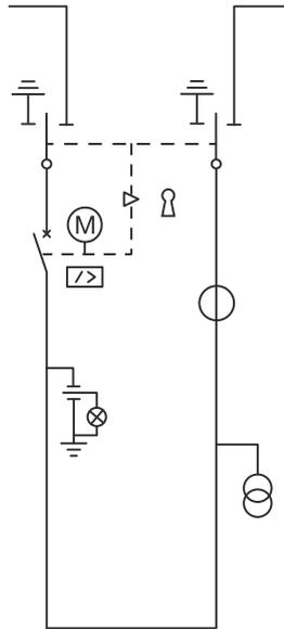
Ячейка состоит из выкатного силового выключателя и двух связанных друг с другом выключателей нагрузки с тремя положениями, работающих параллельно.
