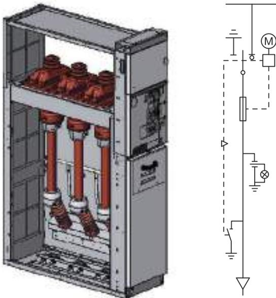
Ячейка выключателя нагрузки с предохранителями типа SFC используется в основном для защиты трансформаторов.
