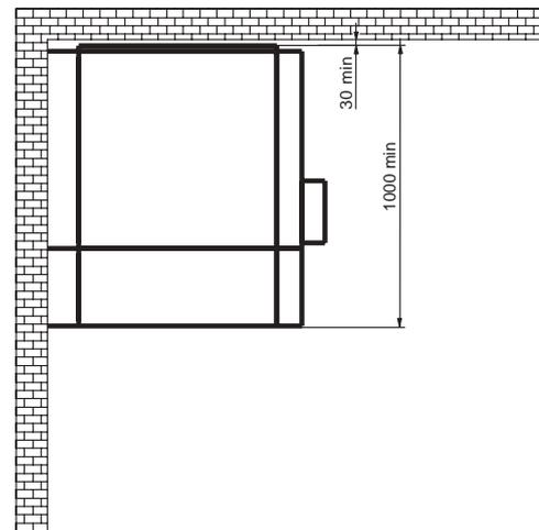
(\*) Не менее 1300 мм для ячеек с выключателем или 1030 мм при использовании специальной дополнительной тележки (только для VD4/R-Сec)
