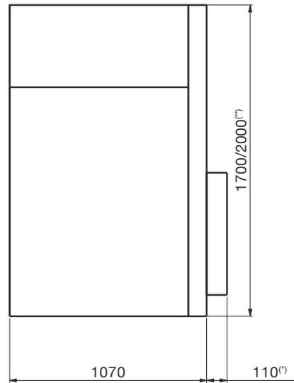
(\*) Для ячеек со съёмными и выкатными выключателями
