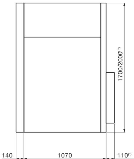
(\*) Для ячеек со съёмными и выкатными выключателями
