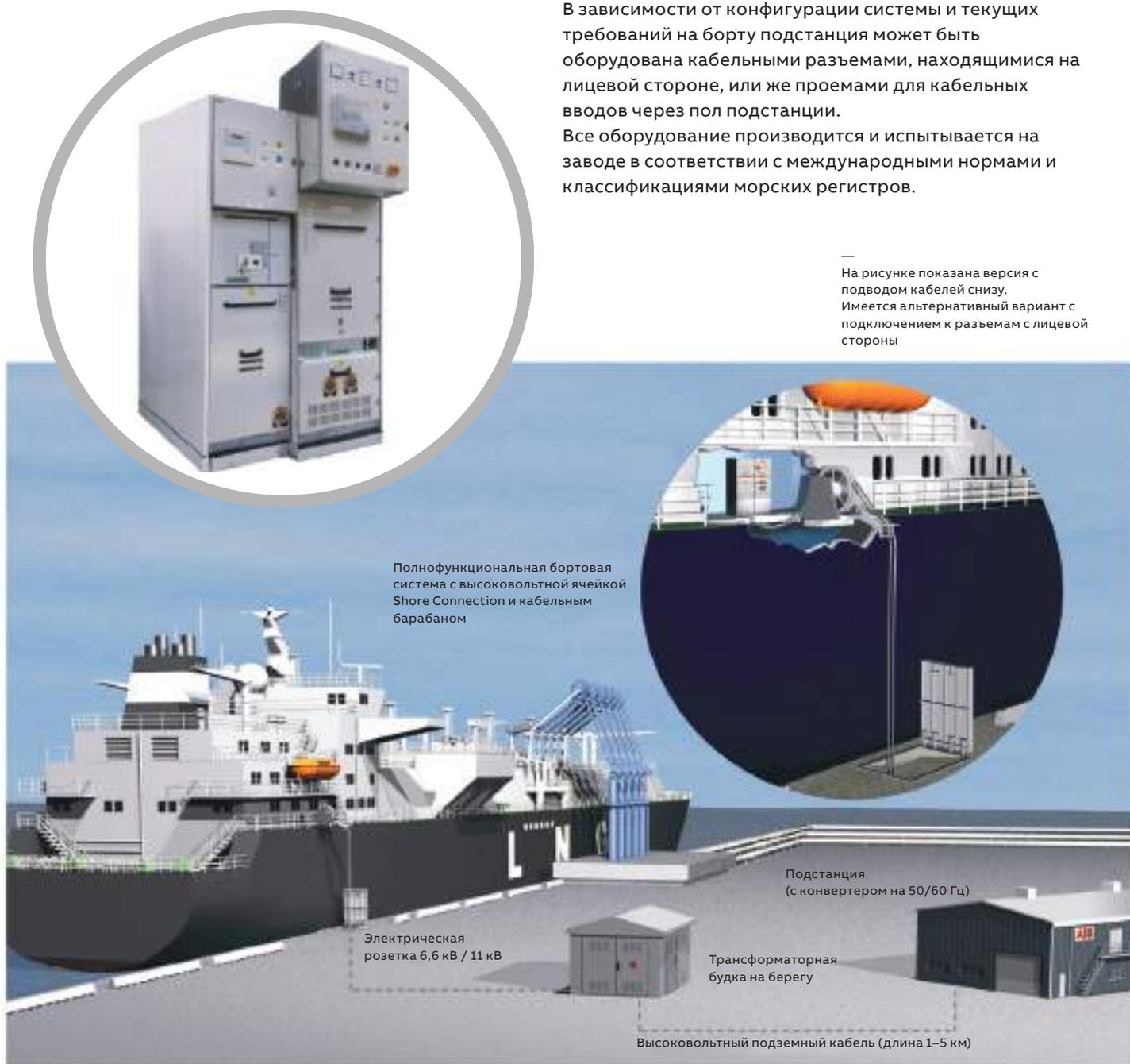
Полнофункциональная бортовая система с высоковольтной ячейкой Shore Connection и кабельным барабаном
