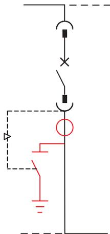
WBS: ячейка секционирования
