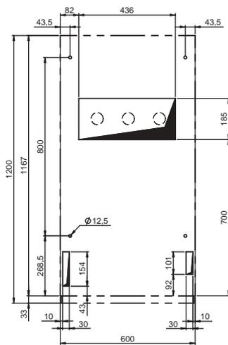
**Ширина 750 мм для ячейки с выкатным выключателем до 24 кВ WBS без выхода кабеля**
