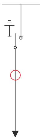
SDC: ячейка ввода/вывода линии с выключателем-разъединителем
