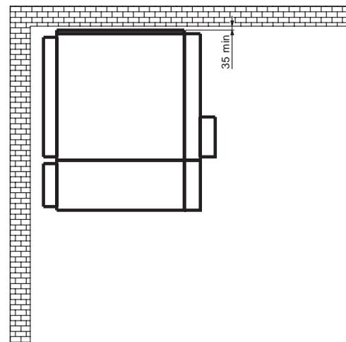
(\*) Не менее 1300 мм для ячеек с выключателем или 1030 мм при использовании специальной дополнительной тележки (только для VD4/R-Sec)
