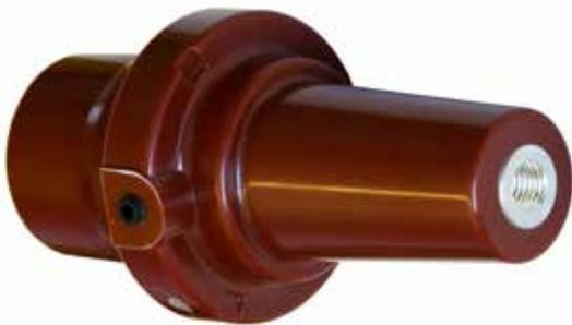
Присоединение высоковольтных кабелей производится при помощи кабельных вводов. Проводники залиты в изолирующий корпус ввода. Дополнительно, в корпусе ввода может находиться проводящий экран, выполняющий функцию ёмкостного делителя для индикации напряжения.
