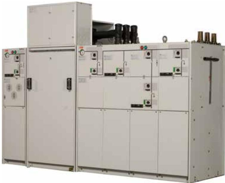
КРУЭ SafePlus может поставляться с модулем V с силовым вакуумным силовым выключателем 630А. В этом разделе описаны различные варианты выбора устройств и терминалов защиты, которые могут использоваться в КРУЭ SafePlus. Для этих устройств требуется установка дополнительного отсека для низковольтного оборудования.
